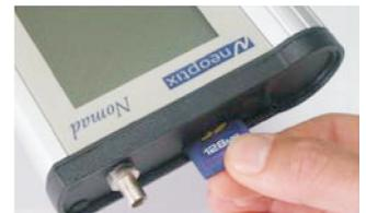
Nomad内置数据存储内存。用户也可以选择使用SD闪存卡对测温数据进行存储。SD闪存卡最高容量为1GB。用户可根据需要使用多个SD卡（一个SD卡存储一个项目的数据）。SD卡内的数据可通过电脑的读卡器进行读取。按下Nomad测温仪上的SnapLog键，即可对单个测温点的数据进行记录，同时附带时间和日期戳。
